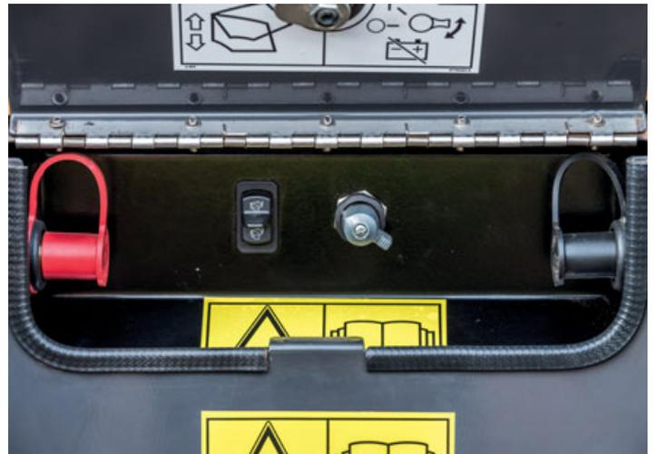
Interruptor de apertura del capó y de encendido/apagado de la batería. El capó puede abrirse externamente con arranque remoto si la batería se descarga.
