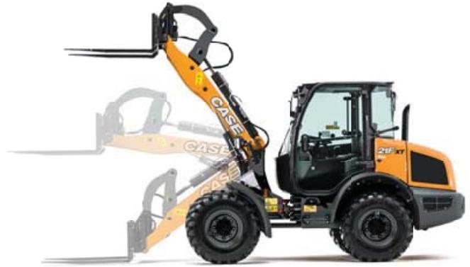
**Z** es el tipo de cinemática más versátil. Ofrece una fuerza de arranque mayor gracias a los 2 cilindros de elevación y una altura de descarga más alta.
