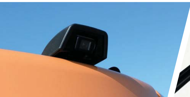
Cámara de visión trasera: más seguridad en la obra.
